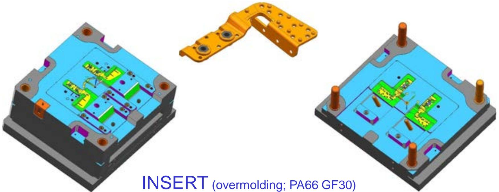
**INSERT** (overmolding; PA66 GF30)
